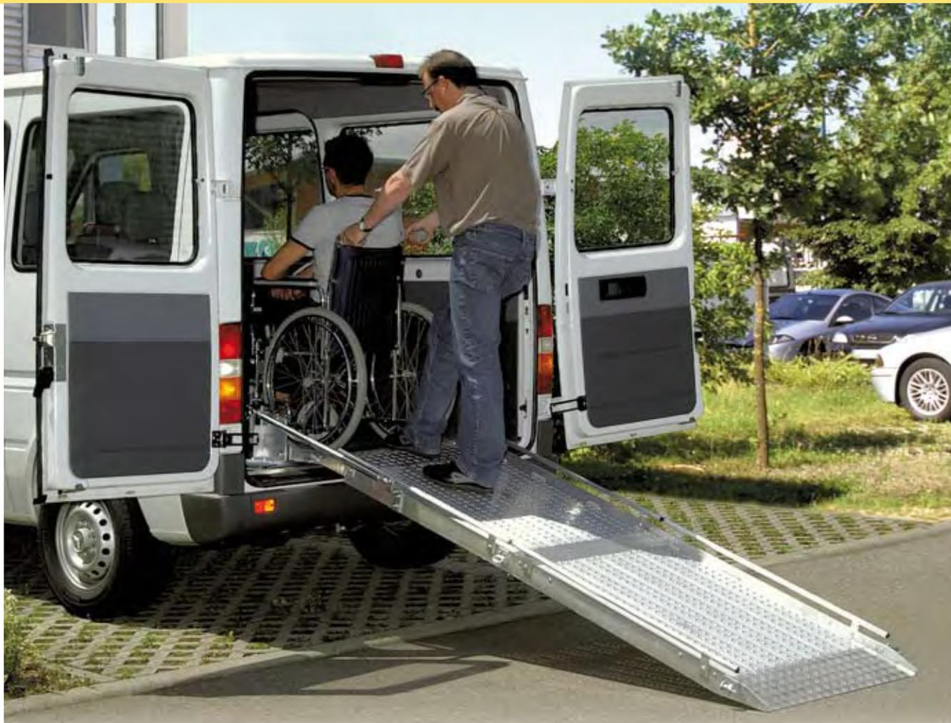
Cette rampe de chargement est conçue pour permettre l'accès à des charges légères à l'intérieur des véhicules. Elle peut convenir au transport de personnes à mobilité réduite.
