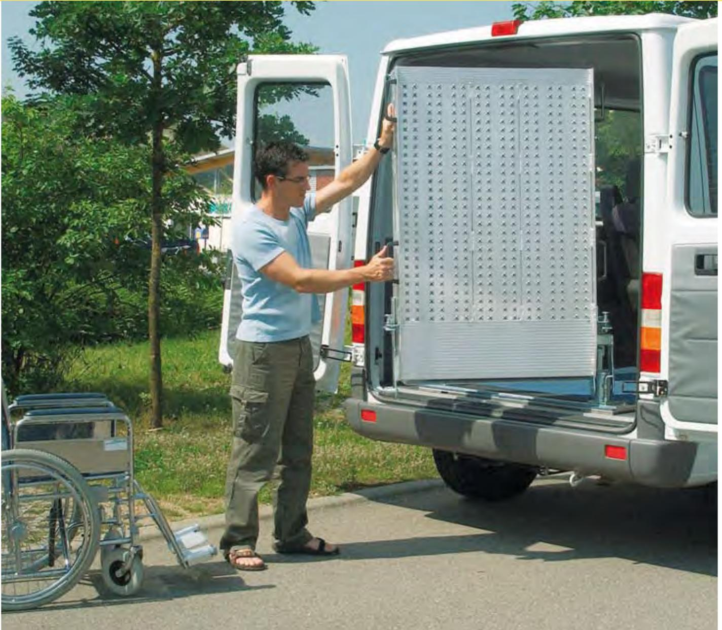
*Modèle polyvalent permettant une orientation à 180°. Particulièrement étudié pour répondre aux demandes d'accès à l'intérieur du véhicule avec ou sans rampe, ce modèle peut être orientée vers l'intérieur ou vers l'extérieur grâce à son pivot latéral situé côté droit (derrière le passager).*
