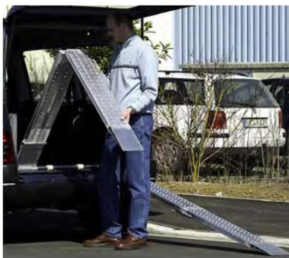
Les rampes sont installées à demeure dans le véhicule. L'articulation et le déplacement latéral se font sur roulements à bille. La surface de roulement antidérapante est perforée par emboutissage. Les trous facilitent l'évacuation de l'eau et des salissures.
