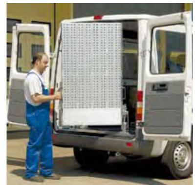
Cette rampe en aluminium est montée sur un pivot permettant de l'orienter vers l'intérieur ou l'extérieur. Cela permet de faciliter l'accès lorsque la rampe n'est pas utilisée.
